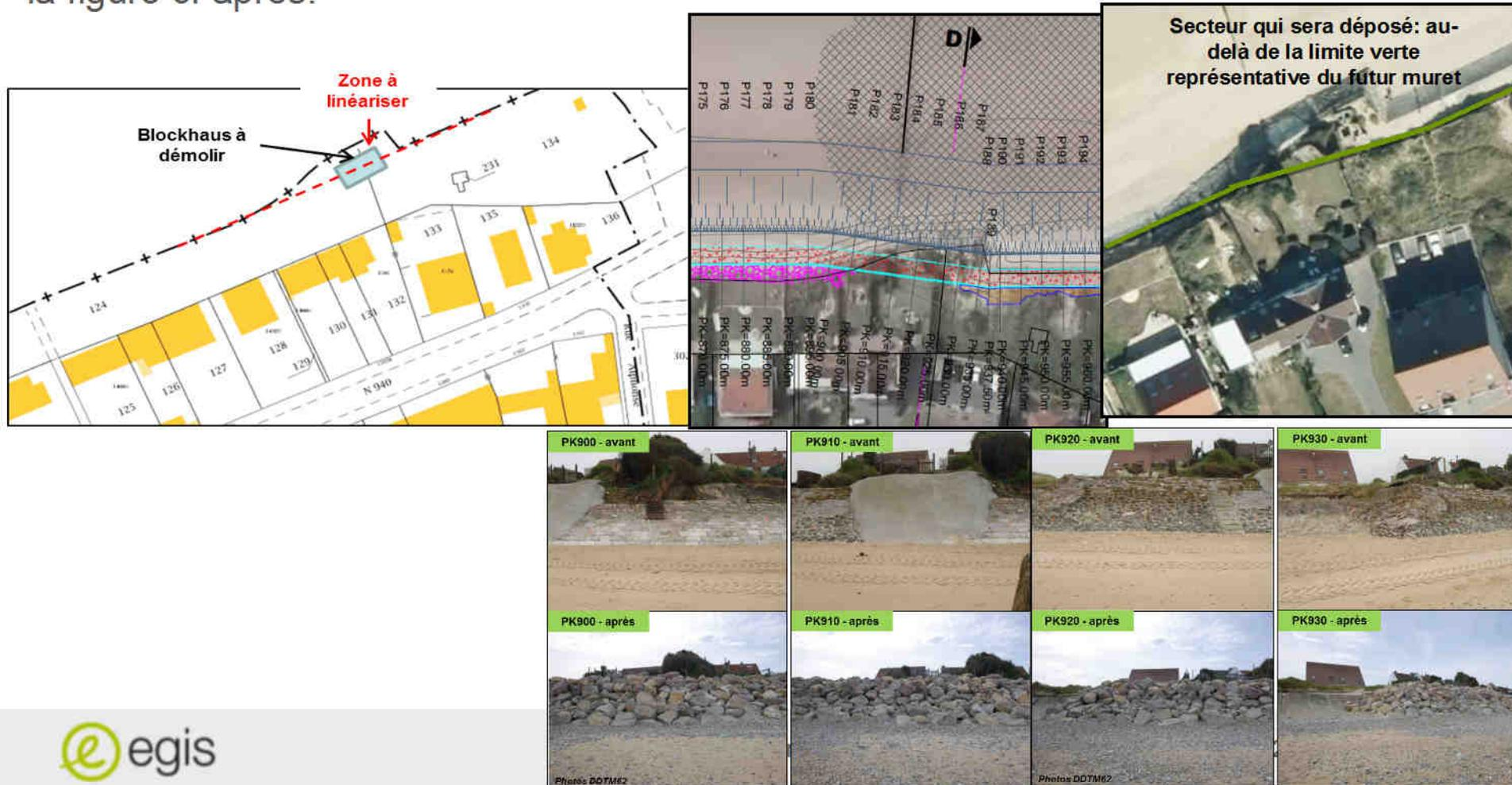
Les démolitions concernent dans un premier temps, la dépose, le tri et le stockage provisoire des matériaux qui composent la protection du haut de plage actuel.
